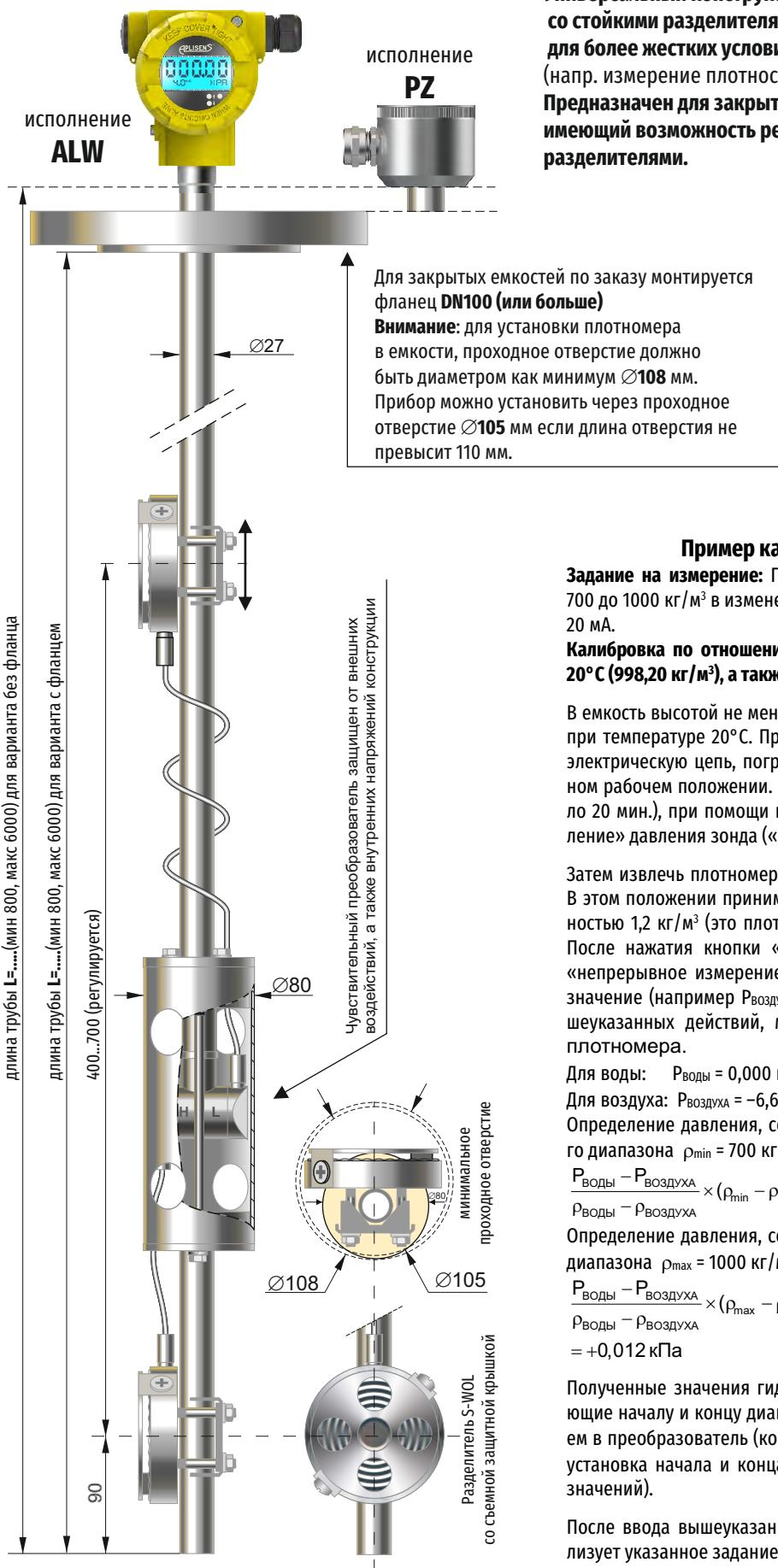
**Универсальный конструктивный вариант со стойками разделителями S-WOL для более жестких условий**
