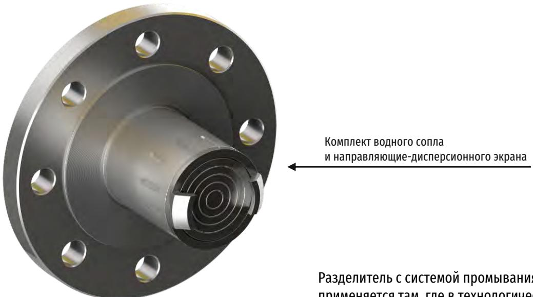
Разделитель с системой промывания применяется там, где в технологическом процессе возникает зарастание мембраны. Периодическая промывка водой или другим растворителем может происходить в ручном или автоматическом режиме.
