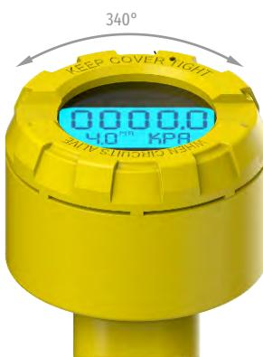
Местный индикатор встроен в корпус, выполненный из алюминия. Конструкция корпуса даёт возможность поворота местного индикатора на 90°, поворота корпуса по отношению к приёмнику давления в пределах 0–340°.
